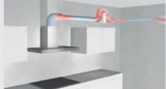
Beispiel einer schlechten Verrohrung
